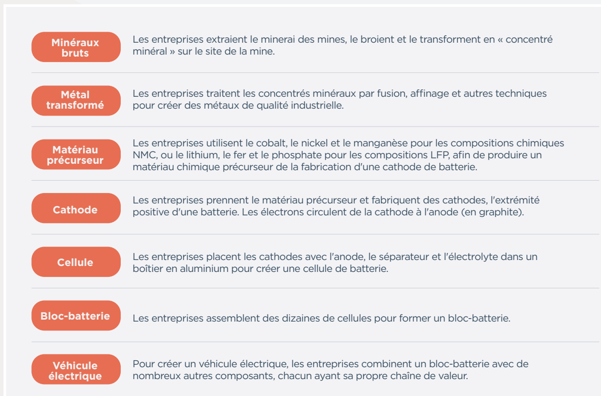
Figure 5 : Chaîne de valeur d'une batterie de véhicule électrique
